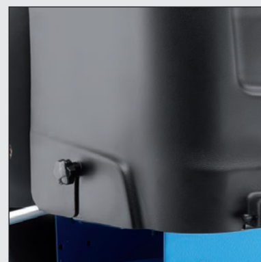
Skrutkovací uzáver pre jednoduchšie otvorenie krytu
