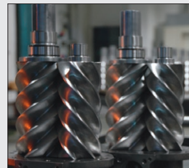
Skrutkový blok S67 s vysokým výkonom
