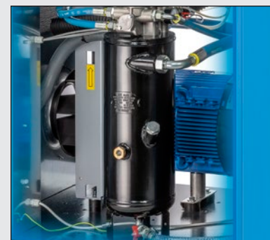
Vertikálna vysoko účinná trojstupňová separácia oleja
